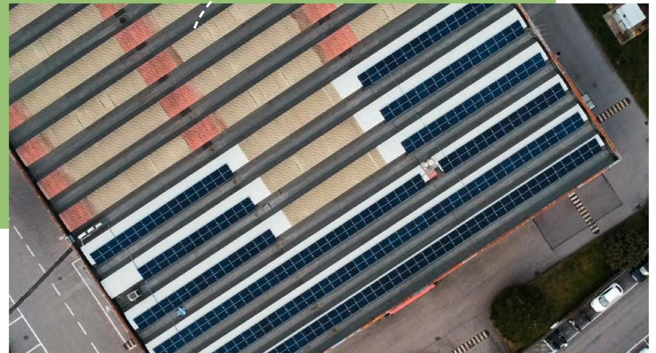
Presso l'headquarter di Seriate sono stati montati **232 pannelli da 430W per una potenza totale di 100 kW.**
